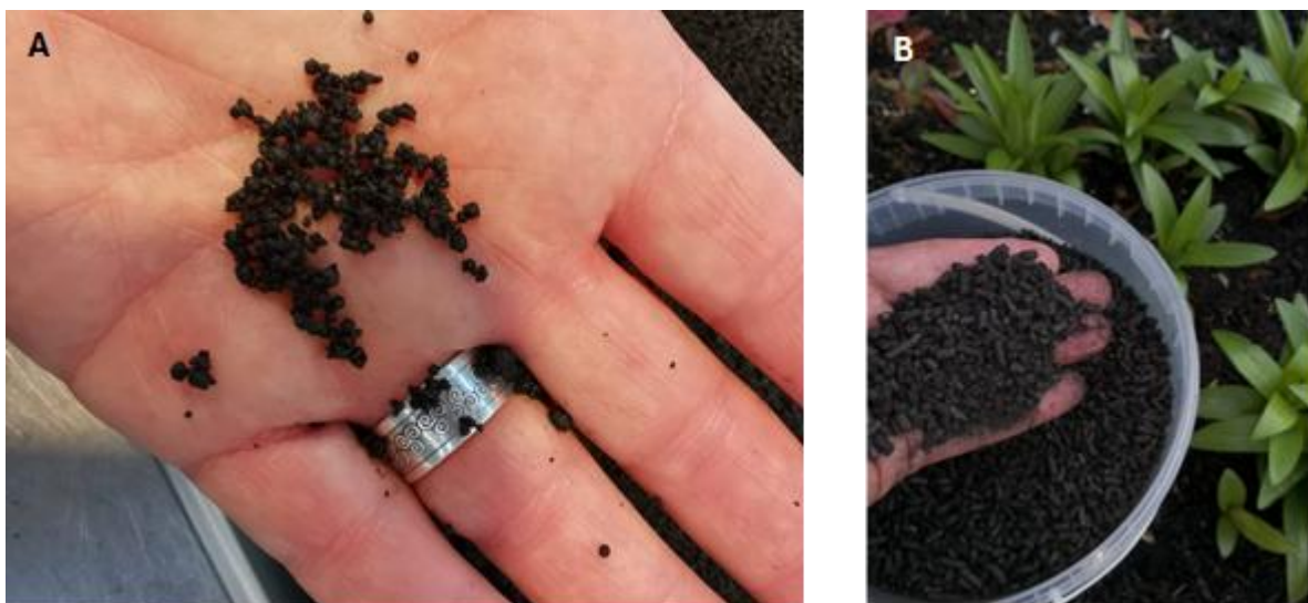
Figuur B1.1 Bio-Based Carbon van STERCORE. A. niet-gepelletiseerd. B. product uit agglomeratietest.
